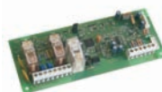
J424/J408 J400-EXT Modulo di estinzione a microprocessore - Extinguisher module with microprocessor control
